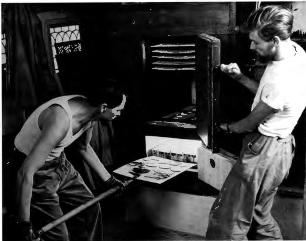
Ralph Bergholtz skjuter in en plåt med glasstycken i brännugnen medan en assistent håller upp luckan. Fotot togs av Georg Oddner i samband med att Marianne Höök skrev ett reportage för magasinet Idun 1952.
